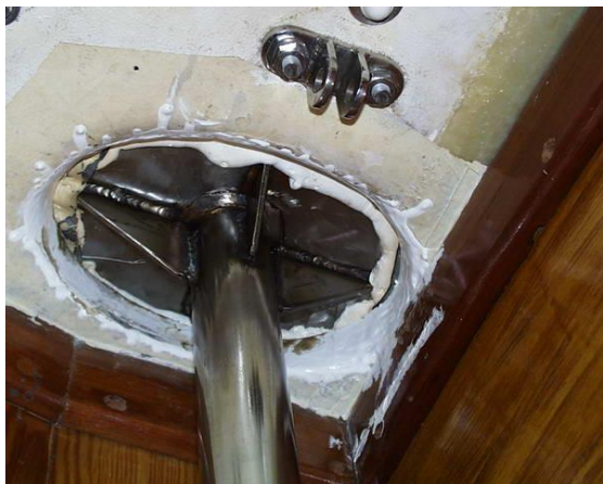
Фото 1. Пиллерс с фланцем из каюты. Видны косынки.
