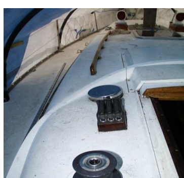
Фото 12. Вентиляционный грибок над камбузом; возле левого вентиляционного короба виден грибок выхлопа отопителя.
