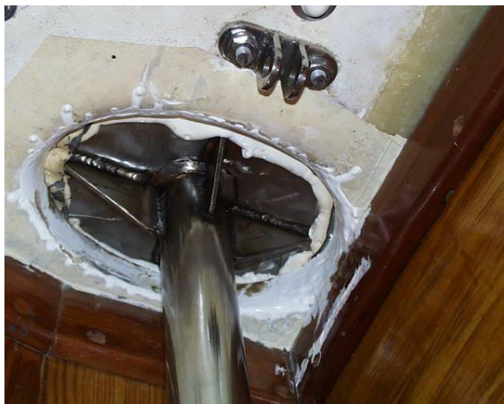
Фото 5. Верхняя точка крепления «струны». Видна часть накладки и приформовка переборки к крыше рубки.
