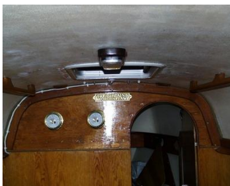
Фото 4. Накладка, стягивающая переборку (устанавливается с обеих сторон).
