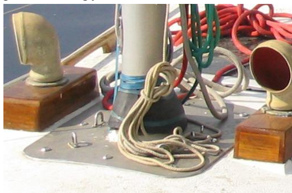
Фото 6. «Ошейник» на палубе. Видны кольца рым-болтов струны и дополнительные U-образные рымы.
