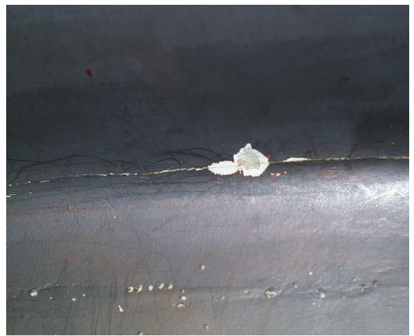
Фото 2,3. Сильные трещины в зализе (киль рукой качался на несколько градусов)
