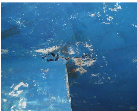
Фото 4. Трещины сопряжения задней кромки и днища
