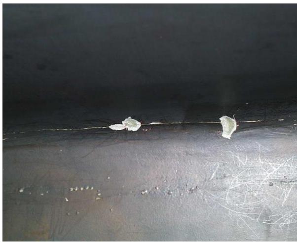
Фото 2,3. Сильные трещины в зализе (киль рукой качался на несколько градусов)
